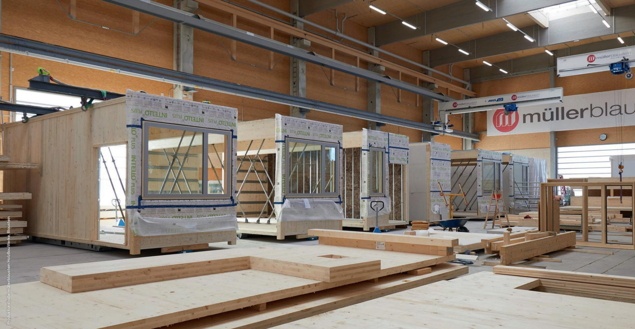
An unseren beiden Standorten produzieren wir selbst – mit Leidenschaft, Präzision und Innovationskraft. Unsere hochmodernen Produktionsstätten stehen für industrielle Fertigung auf höchstem Niveau: digital geplant, wetterunabhängig und mit einem Vorfertigungsgrad von bis zu 90 Prozent.
